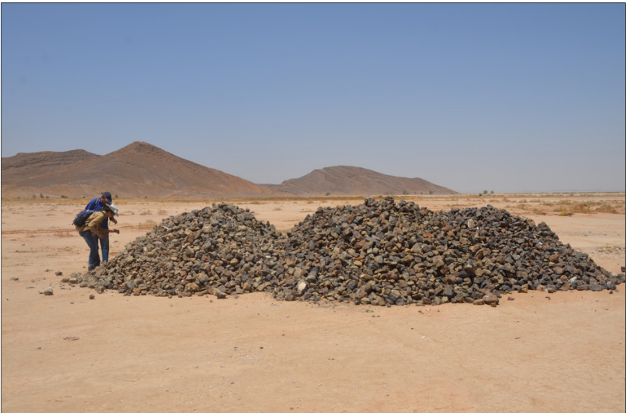
Fig. 11-10 – Amas de galènes exploitées récemment et stockées en attente de leur transport vers un lieu de réduction. Photo : Mission archéologique maroco-française, 2015.
