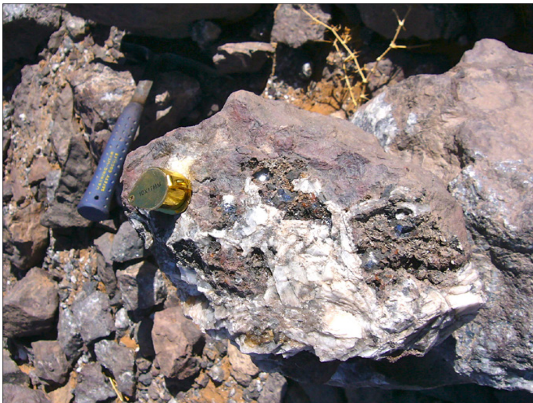
Fig. 11-16 – District minier de Mfis. Échantillon 8 montrant des cristaux de galène tapissant les limites de veinules centimétriques et faisant ainsi le contact avec l'encaissant rouge riche en trace d'oxydation (Minéralisation Type I). Photo : Mission archéologique maroco-française, 2015.
